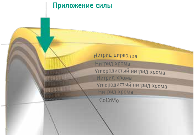
Повышенная плотность покрытия
