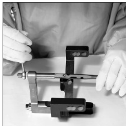
Соединяем штифт с направителем винтом-стяжкой и подтягиваем ключом S=11мм
